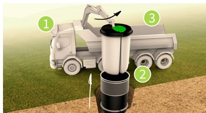
1. Nákladní vůz s jeřábem 2. Vyjměte vak z kontejneru 3. Vyprázdněte vak
