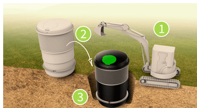
1. Vykopejte díru 2. Umístěte ZBin do výkopu 3. Obsypte kontejner
